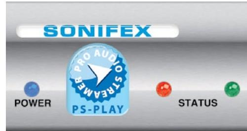
Fig 3-2: PS-PLAY Power & Status LEDs
